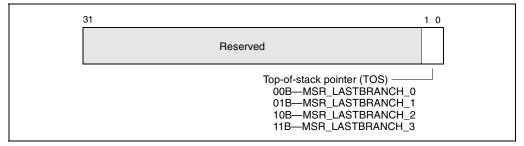
Figure 15-4. MSR\_LASTBRANCH\_TOS MSR Layout
