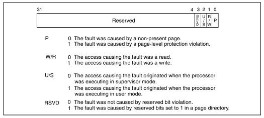
Figure 5-7. Page-Fault Error Code
